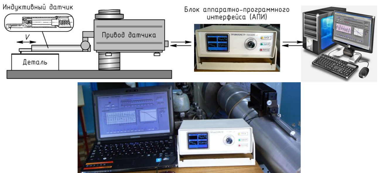
Рисунок 3.14 – Информационно-измерительная система ИИС-3 для измерения параметров шероховатости и волнистости поверхностей
