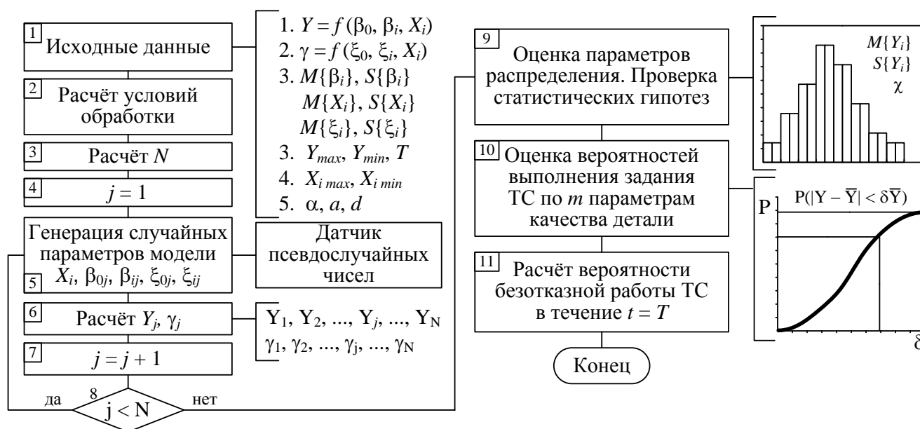
Рисунок 2.13 – Блок-схема расчёта параметрической надёжности ТС по параметрам качества деталей методом статистических испытаний (Монте-Карло)
