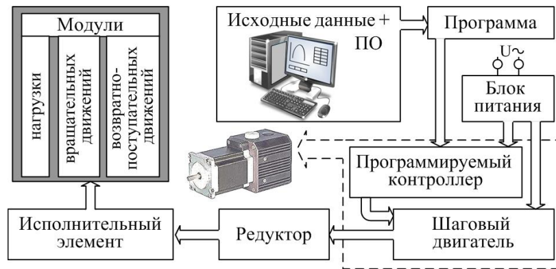
Рисунок 8.7 – Автоматизированный привод управления модулями испытательных стендов для определения параметров эксплуатационных свойств поверхностей деталей
