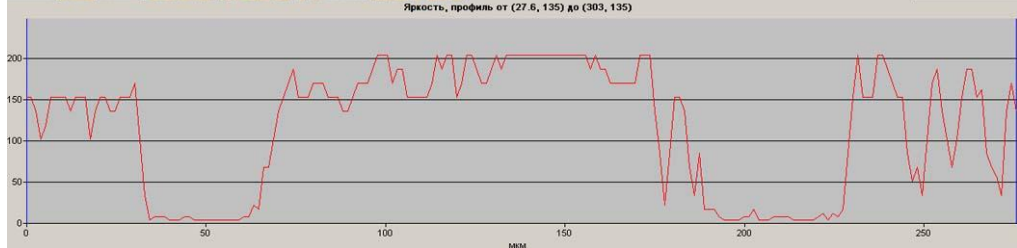
Рисунок П.14.4 – Поверхности трибоэлементов (пара 713): а – шероховатость после приработки (а); микрофотографии поверхности вала, гистограммы и профили яркости: б – до и; в – после приработки ( V_{np} = 10 м/мин; P_{np} = 30 Н/мм; \Delta P = \pm 15\% )
