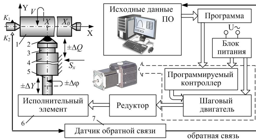
Рисунок 7.15 – Блок-схема программируемого блока обработки ППД инструментом упругого действия для закономерного формирования ПКПС деталей на токарных станках
